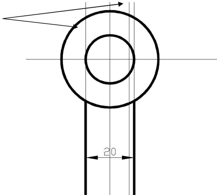
При помощи команды Подobie на слое построение создайте отрезки (см. рис), затем в **Основные линии** слое с помощью привязок прочертите 2 параллельных отрезка, как показано на рисунке
