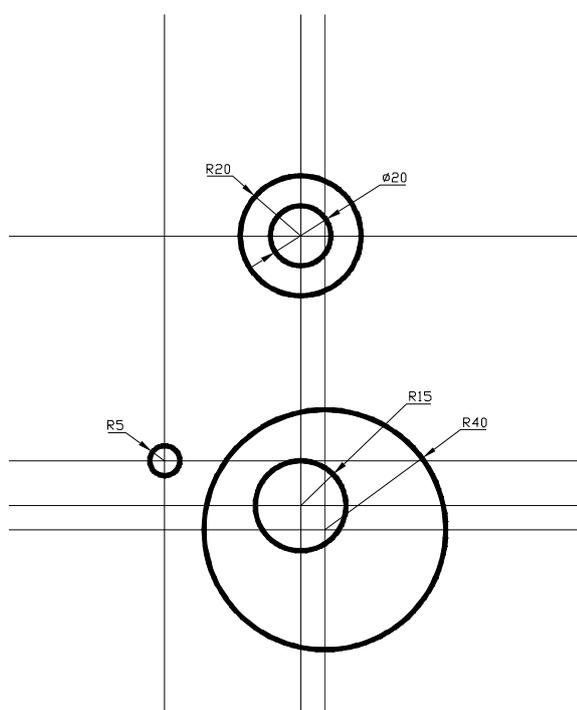
4. Создание линий построения для параллельных отрезков (слой построение).
